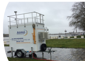
Cabine de mesure mobile installée sur les quais de Bordeaux
